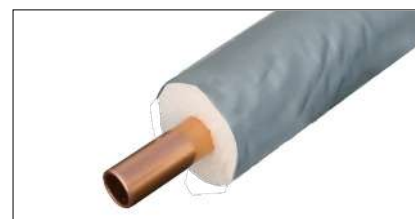
Sp. Isolante da 6 A 10 mm 6 mm: 1/4 - 3/2 - 1/2 10 mm: 5/8 - 3/4 sp. rame 0,8 mm
