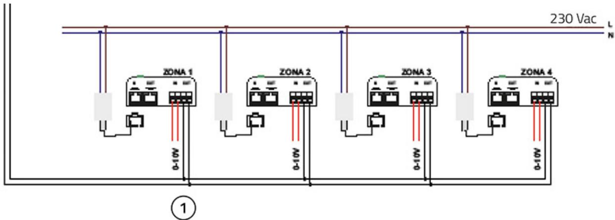
[1] 0-10V: Steuerung durch ein Hausautomatisierungssystem oder einen 0-10V-Regler - die Klappe öffnet modulierend entsprechend der Spannung
