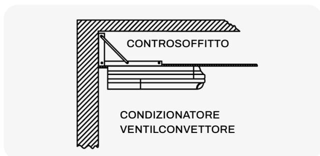
Indicate per il fissaggio di tutti i tipi di condizionatori e ventilconvettori a soffitto
