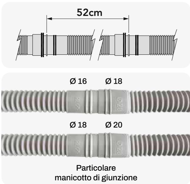
Il tubo di scarico condensa è realizzato in polietilene con doppio rivestimento anti UVA e viene confezionato in rotoli da 50 m. Ogni 52 cm circa sono presenti dei manicotti di giunzione da Ø16/18 e Ø18/20 alternati, questo permette di tagliare il tubo a misura scegliendo la giunzione corretta e desiderata.
