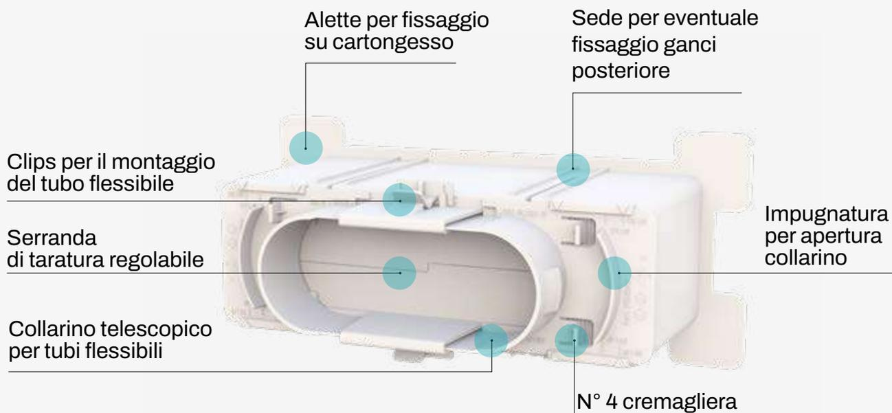
**DETTAGLIO COLLARINO POSTERIORE TELESCOPICO PER TUBI FLESSIBILI DI VARI DIAMETRI (125-160-200-250)**
