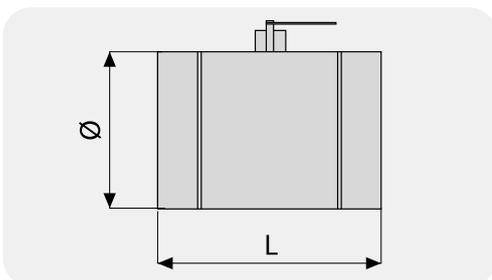
La serranda di regolazione per canali ad azionamento manuale **consente la regolazione del flusso d'aria nel condotto di ventilazione.**
