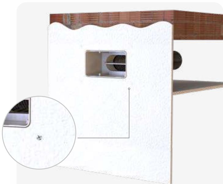
Fissaggio tramite viti
