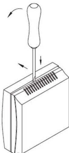
Um das Gehäuse zu öffnen, führen Sie einen Schraubendreher (2.0) in die Mitte des Schlitzes ein, drücken ihn nach unten und heben den unteren Rahmen leicht an.
