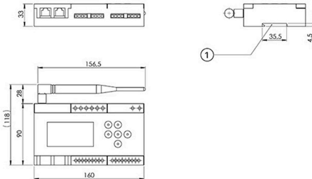
[1] DIN-Führungsanschluss IEC/EN 60715
