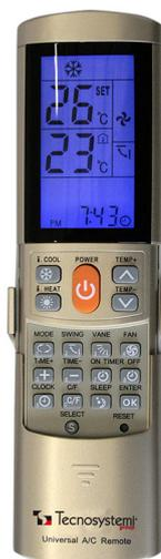
Die Fernbedienung ist mit einem patentierten System zur Suche des Benutzungscodes für den Betrieb des Klimageräts ausgestattet.
