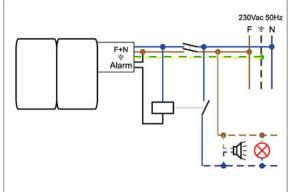
Die RW-MINI Sprühpumpe verfügt über einen doppelten Alarmkontakt C-NO-NA 16A. Den elektrischen Anschluss entnehmen Sie bitte den Schaltplänen in dieser Anleitung. Es wird empfohlen, den Alarmkontakt zur Unterbrechung des Innengeräts zu verwenden. Wichtig: Unterbrechen Sie niemals die Stromversorgung zur Sprühpumpe.
