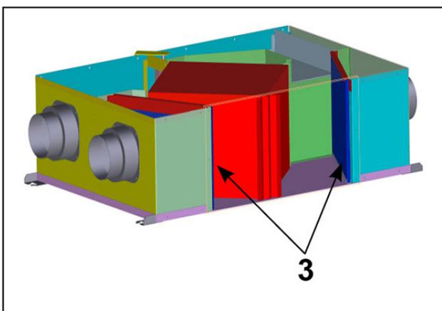
Die Filterstruktur, die sich an jedem Frischluftein- und -auslass befindet, ermöglicht es, den Filter von der Seite zu entfernen.
