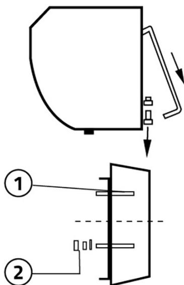
Schrauben Sie die Montageplatte ab und entfernen Sie sie
