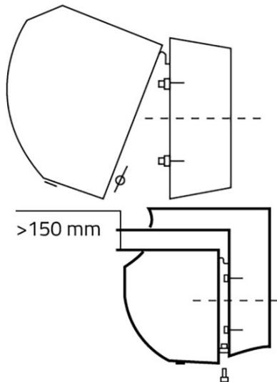
Positionieren Sie die Montageplatte und befestigen Sie sie.
