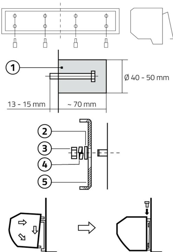
Schrauben Sie die Montageplatte ab und entfernen Sie sie
