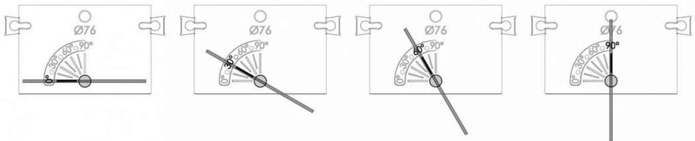
Mithilfe eines Schlitzschraubendrehers kann der Stellschieber eingestellt und der Luftstrom im Innern des Installationsraumes ausgeglichen werden.
