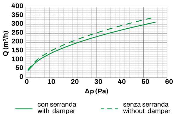
Schlitz von 20 mm mit oder ohne Schieber, geneigte Störklappe
