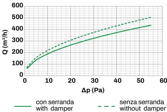
Schlitz von 30 mm mit oder ohne Schieber, geneigte Störklappe
