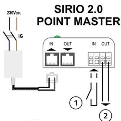
[1] Contact en position fermée : ouvre le registre ; contact en position ouverte : ferme le registre
