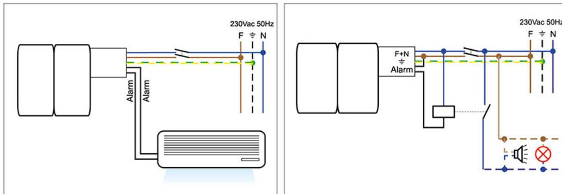
La pompe de pulvérisation RW-MINI possède un double contact d'alarme C-NO-NA 16A. Pour le branchement électrique, se référer aux schémas électriques de cette notice. Il est recommandé d'utiliser le contact d'alarme pour arrêter l'unité intérieure. Important : ne coupez jamais l'alimentation électrique de la pompe de pulvérisation.
