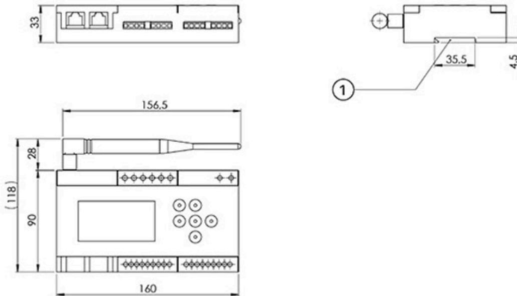
[1] Raccord pour guide DIN IEC/EN 60715
