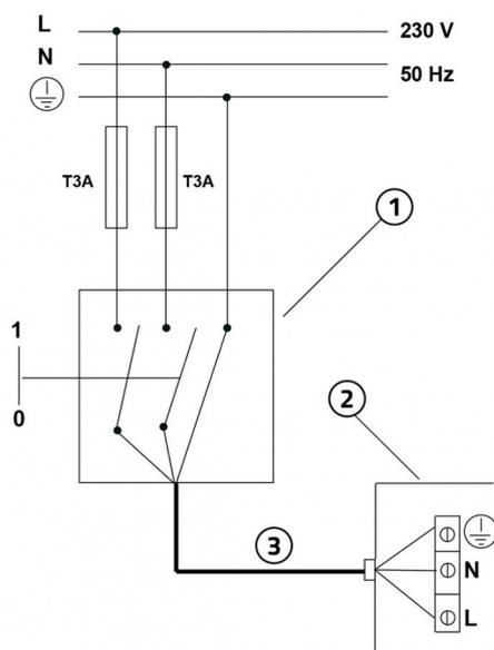
[1] interrupteur de protection magnétothermique omnipolaire conforme à EN 61508:1
