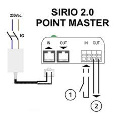
[1]Contact en position fermée : ouvre le registre ; contact en position ouverte : ferme le registre
