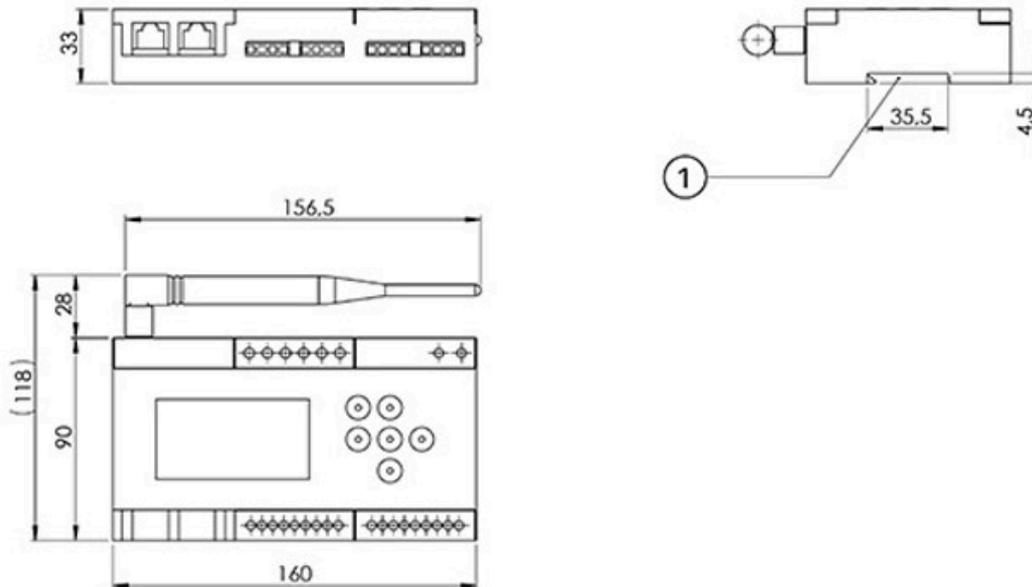
[1] Raccord pour guide DIN IEC/EN 60715
