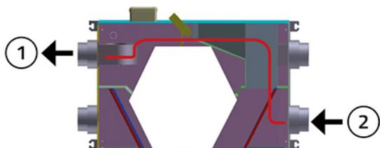
Quando le condizioni dell'aria esterna sono buone e cioè con una temperatura in estate più fresca della temperatura dei locali la serranda di by pass interna entra automaticamente in funzione ed esclude il recuperatore a flussi incrociati in modo da non ridurre le caratteristiche confortevoli dell'aria esterna rispetto a quella interna e ridurre i consumi di energia per la ventilazione.
