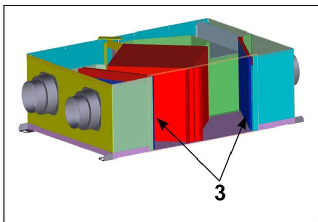
La struttura filtrante posta ad ogni ingresso ed all'uscita dell'aria di rinnovo consente di estrarre il filtro lateralmente. Sequenza operativa:
