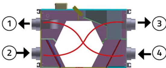
Mettendo in funzione il recuperatore di calore, quando la qualità dell'aria scende sotto il livello di comfort, viene immessa nei locali dell'aria proveniente dall'esterno.
