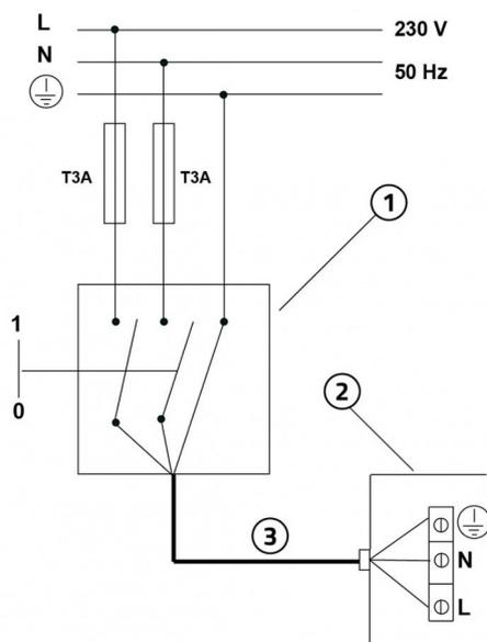
[1] Interruttore di protezione magneto-termica onnipolare conforme a EN 61508:1
