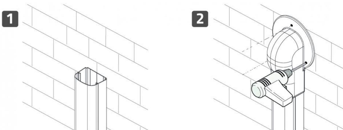
**ESEMPIO DI FISSAGGIO CON SILICONE E VITI**
