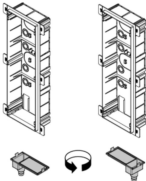
In base al lato di passaggio delle tubazioni è possibile scegliere il senso di montaggio del sifone.
